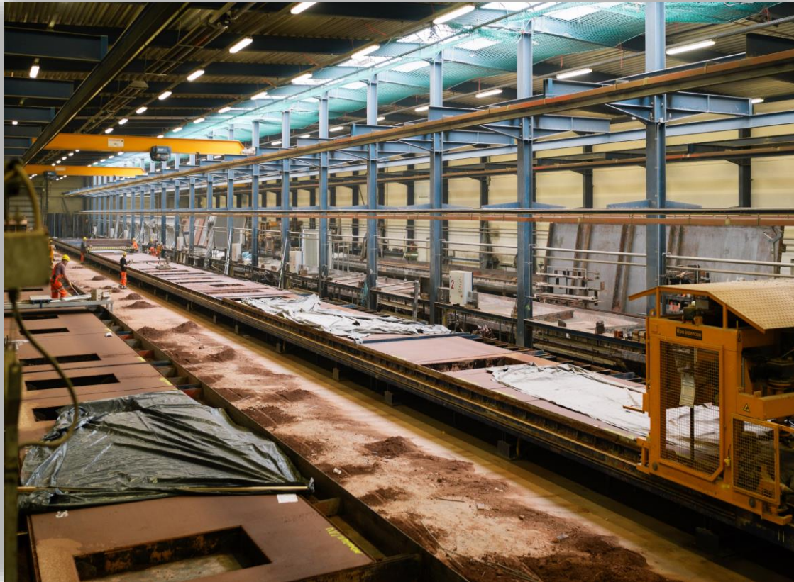
Produktion Tinglev, 2024, erdfeucht, reduzierter Wasserverbrauch, ausschließlich Transportbewehrung, 120 m lange Tischanlage in der Halle 1
